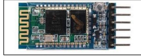
Fig. 5: HC-5 Bluetooth module
