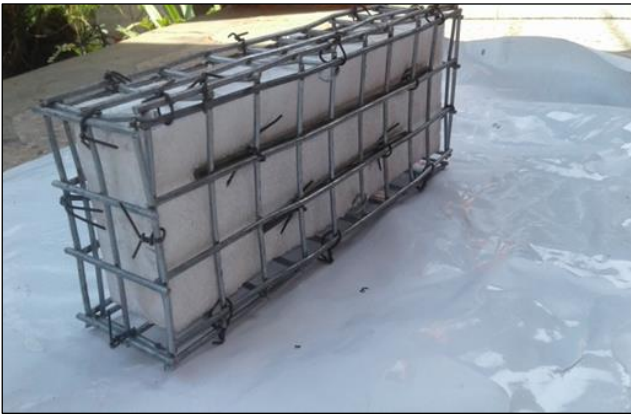
Fig. 2: EPS Panel of size 300mm×100mm×75mm
