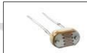
Fig. 3.3 A: LDR SENSOR
