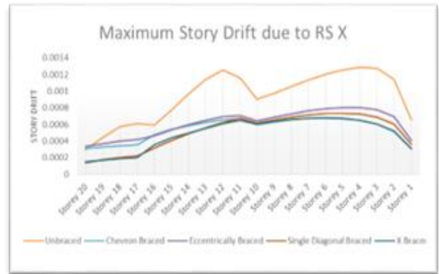
Fig. 17: Storey drift due to RS X
