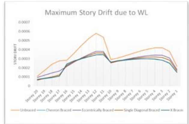
Fig. 18: Storey drift due to WL
