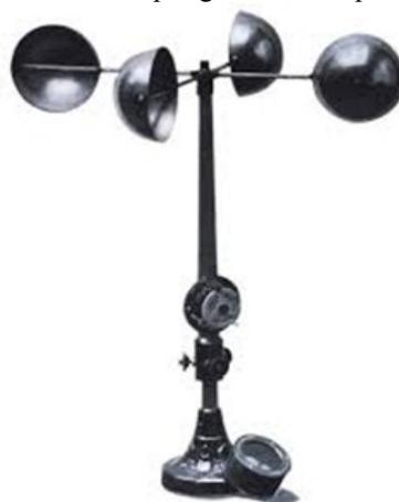
Fig. 4: Anemometer
