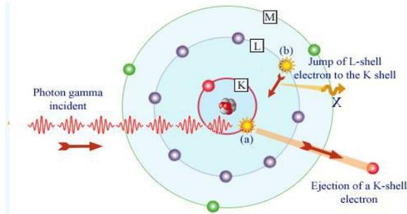
Fig. 2: Production of X-Rays
