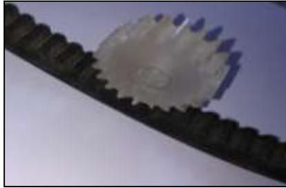
Fig. 8: Rack & Pinion
