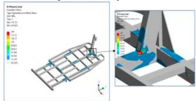
Fig. 8: Von Mises Stress Plot
