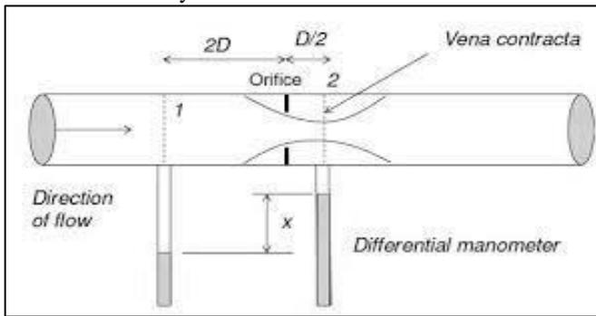
Fig. 2: Orifice meter
