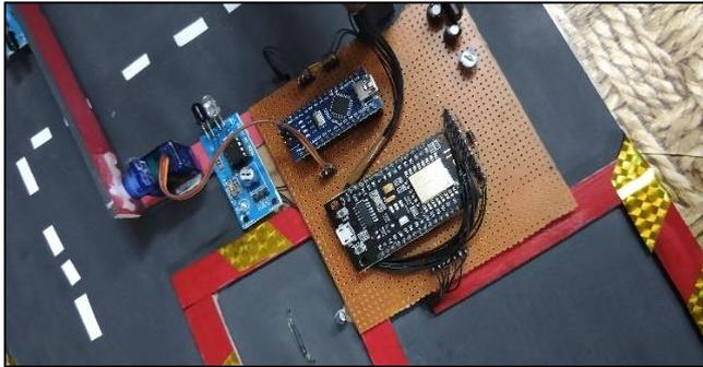
Fig. 9: Arduino nano & NodeMCU
