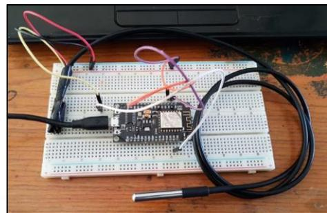
Fig. 3: DS18B2 Sensor Interfacing
