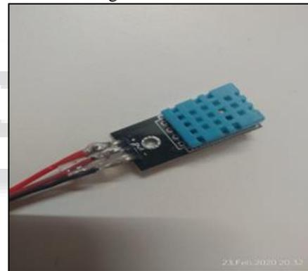
Fig. 3: DHT11 Sensor
