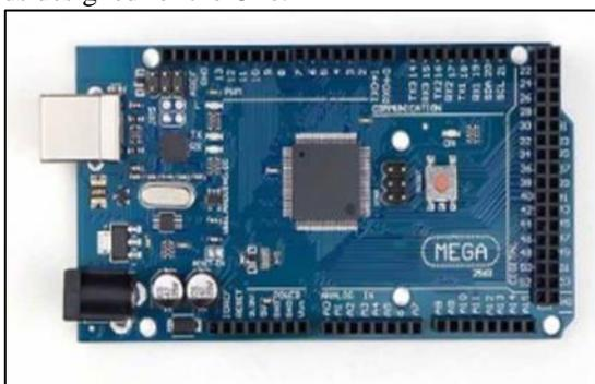
Fig. 1: ARDUINO MEGA 2560
