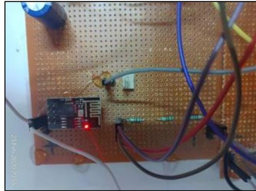
Fig. 2: ESP8266 Module
