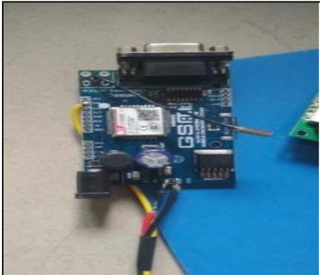
Fig. 3: GSM Module.
