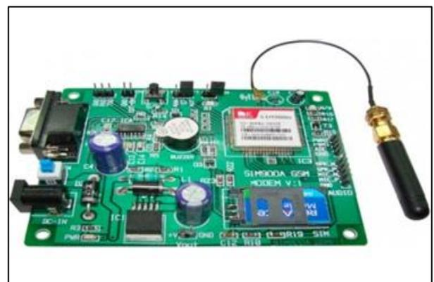
Fig. 1.5: GSM Module
