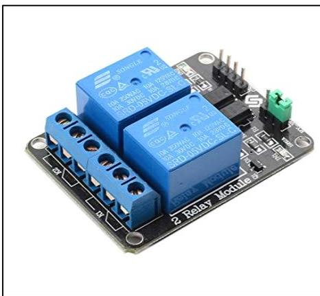
Fig. 3: Relay Module
