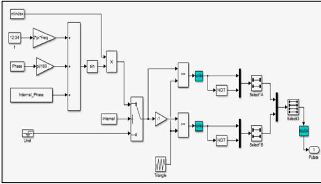
Fig. 3.5: PWM Circuit
