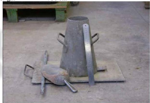
Fig. 2: slump Test
