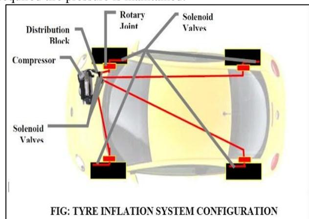
FIG: TYRE INFLATION SYSTEM CONFIGURATION
