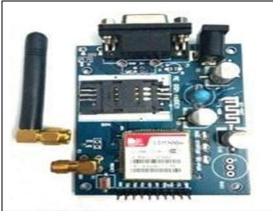
Fig. 5: GSM Module
