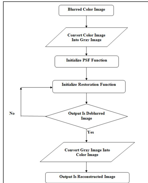
Figure (d) – Flowchart Of Image Deblurring By Using Blind Deconvolution Method
