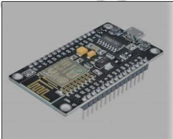
Fig. 3: NodeMCU
