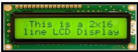
Fig. 4: LCD Display
