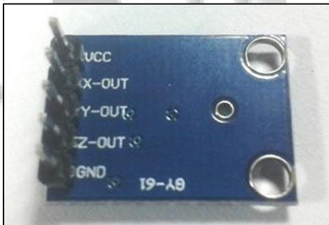
Fig. 4: Accelerometer
