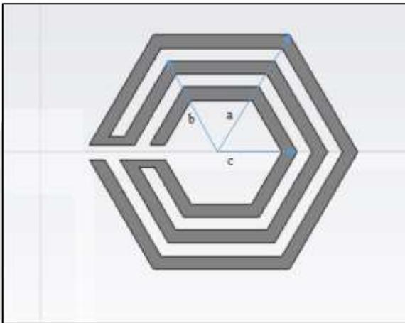
Fig. 2: Spiral hexagon resonator ( $a=4.5\text{mm}$ ,  $b=3.5\text{mm}$ ,  $c=2.5\text{mm}$ )
