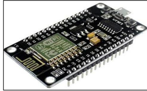
Fig. 7: ESP8266 (NodeMCU) Module
