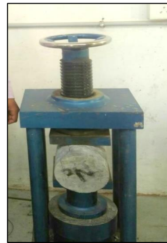
Fig. 5: Spilt tensile strength test
