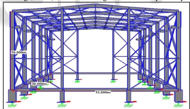
Fig. 1: 15 M Span P.E.B
