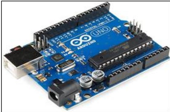
Fig. 1: Arduino Uno Module
