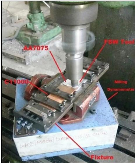
Fig. 3.1: Milling Dynamometer
