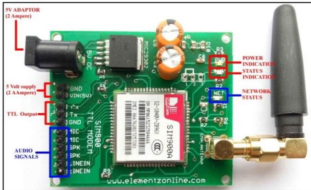
Fig. 5: GSM Module
