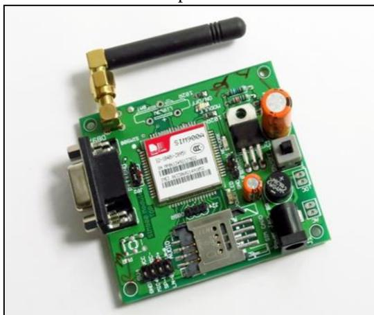
Fig. 2.5: GSM module
