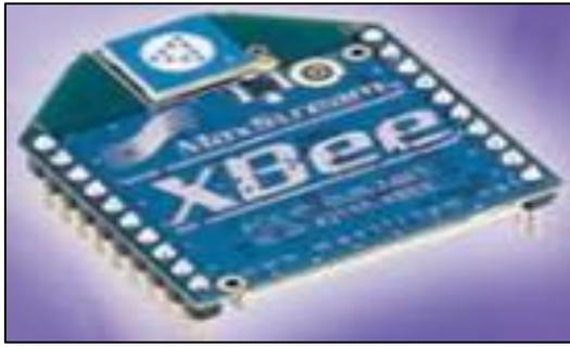
Fig. 3: Zigbee Module
