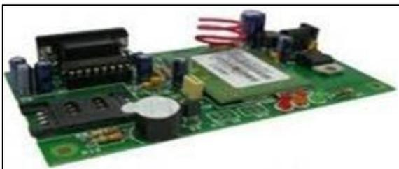
Fig. 4: GSM Module
