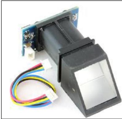
Fig. : Fingerprint scanner
