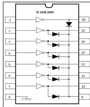
Fig. 5: Driver IC ULN 2003
