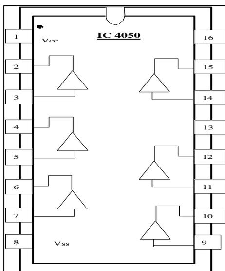
Fig. 4: Buffer IC 4050
