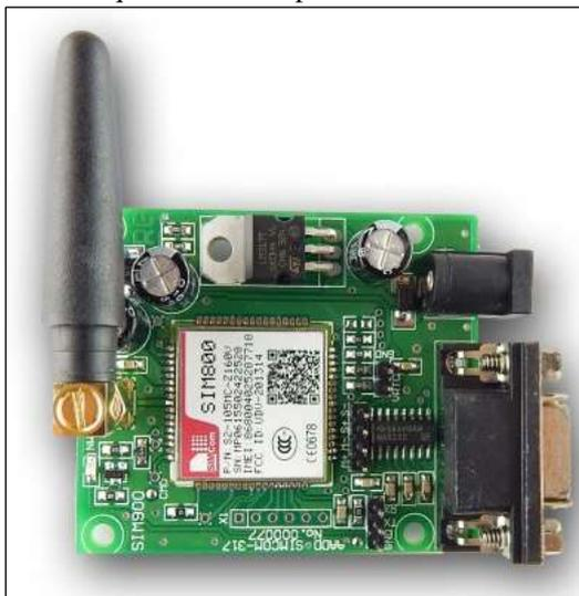
Fig. 4.5: GSM Module
