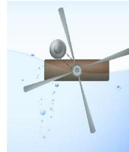
Fig. 1: In-plane axis [2]
