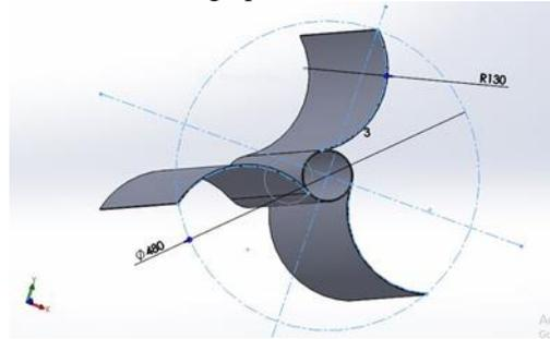
Fig. 8: savonius rotor blade
