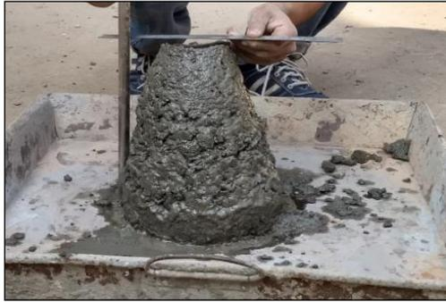
Fig. 3: Slump Test
