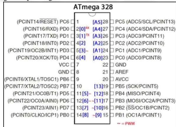
Fig. 3: ATmega 328 Pin Diagram
