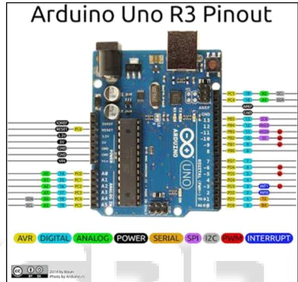
Fig. 2: Arduino UNO Diagram 1
