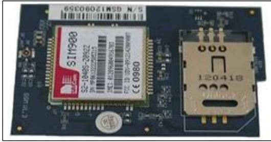
Fig. 4: GSM Module
