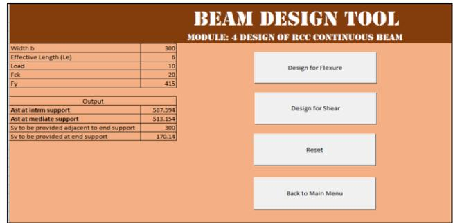
Fig. 10: Snapshot of Module: 4
