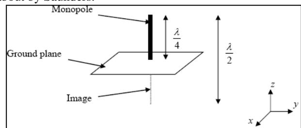
Fig. 2.2: Monopole Antenna
