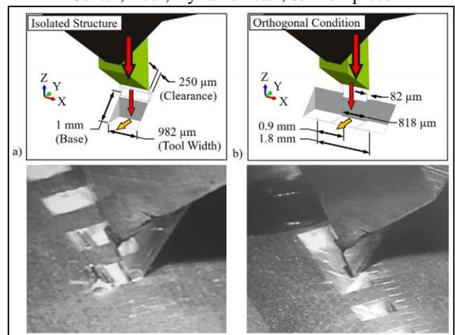
Fig. 2: Cutting Scenarios: A) Isolated, And B) Orthogonal
