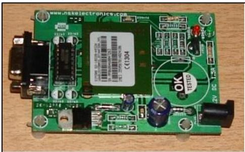
Fig. 2: GSM Module
