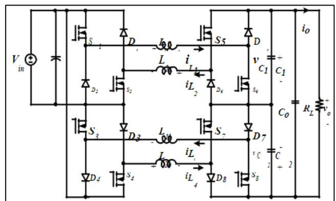
Fig. 3: Quasi Single-Stage Buck-Boost Inverter
