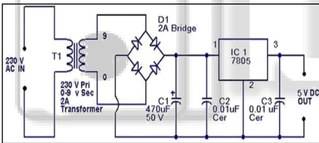
Fig. 5: Rectifier Circuit
