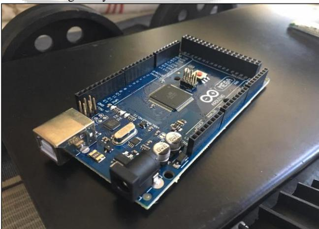
Fig. 2: Arduino Mega 2560
