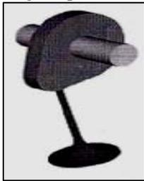
Fig. 2: Single Cam & Valve
