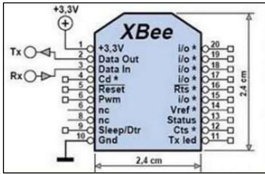
Fig. 3: ZigBee Pro pins
