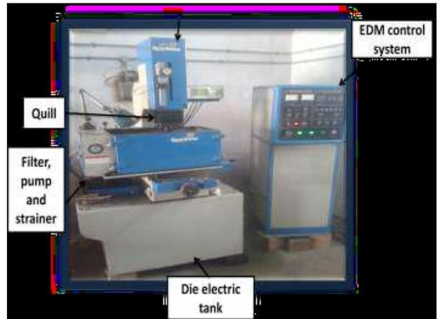
Fig. 3: Experimental Setup (S25 Sparkonix EDM)
